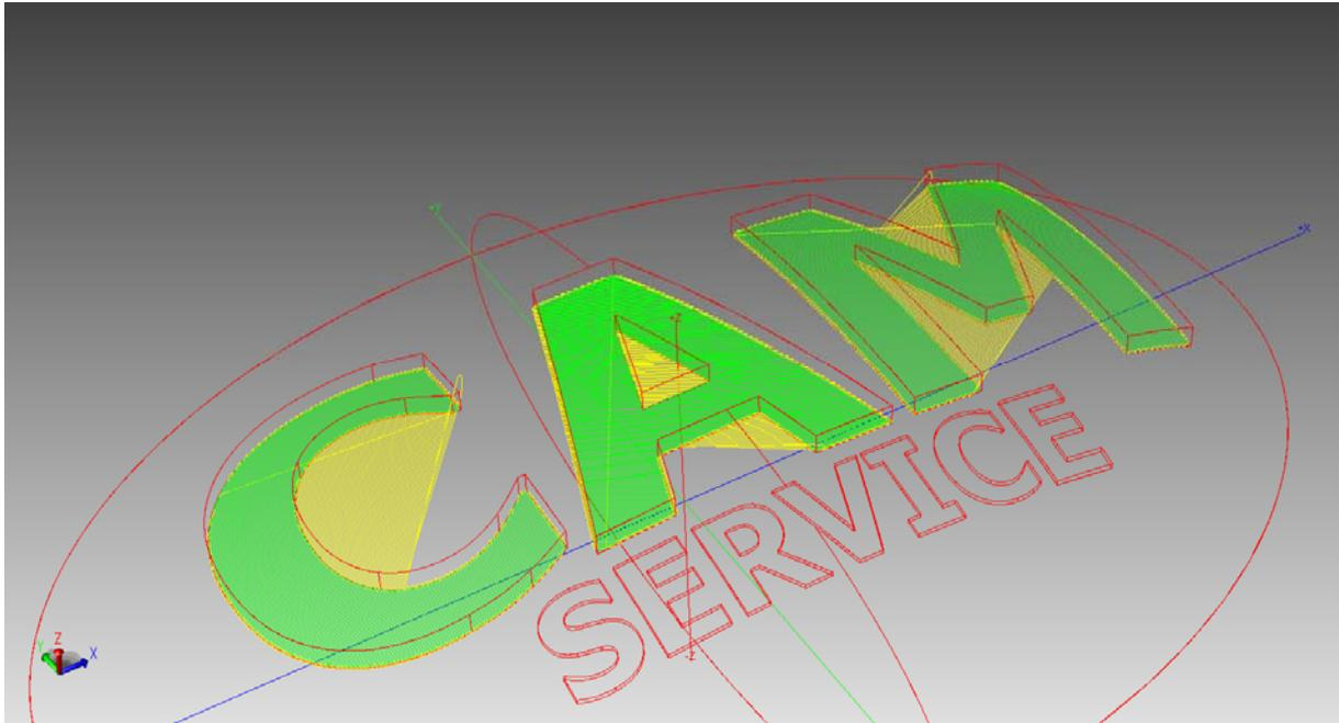
**Bild 6:** Abtragen gekrümmter Oberflächen z.B. mit 3 Achsen-Scanner. 3D Schraffur mit ‚Sky writing‘ und unterschiedlicher Schraffurrichtung der Ebenen
