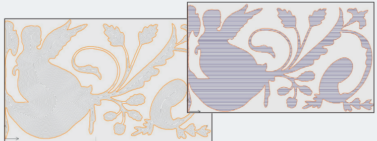
Aequidistante oder lineare Füllung beliebiger Konturen (Hatching) WZ-Offset durch G41/42 oder Neuberechnung der Bahnen möglich
